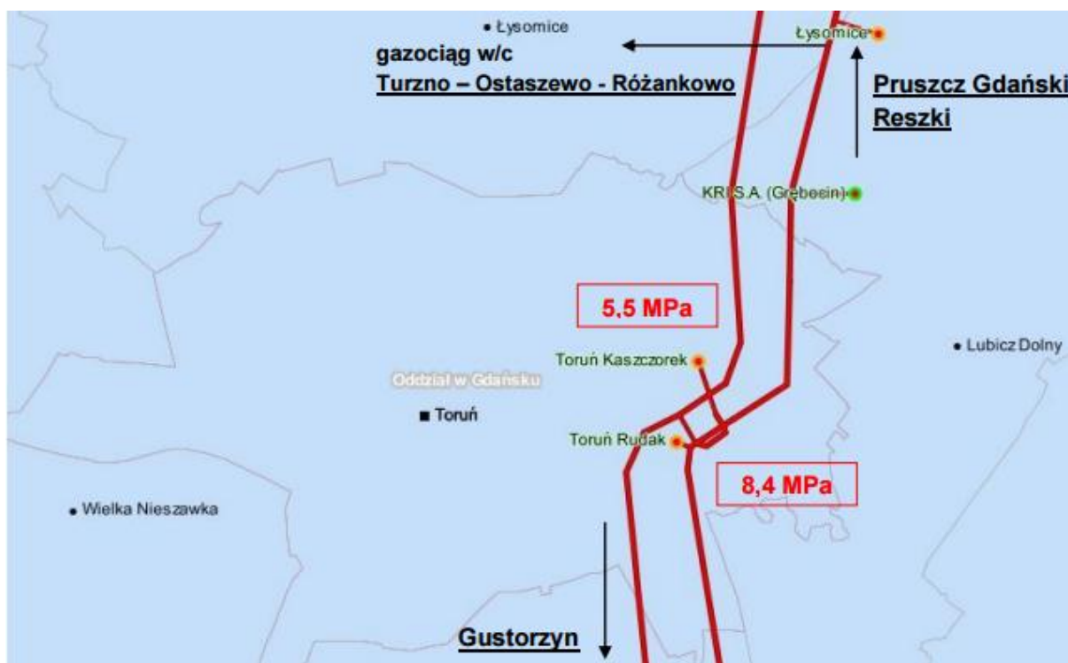
Rysunek 2 System gazociągów przesyłowych zasilających miasto Toruń
