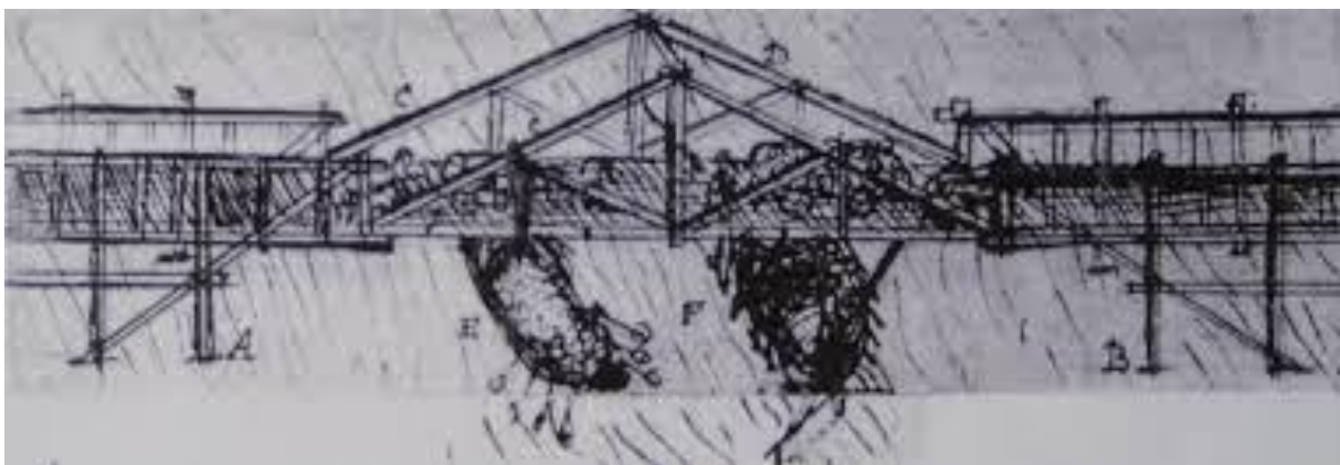
Ryc. 12 Ruchome przęsło środkowe w części mostu niemieckiego
